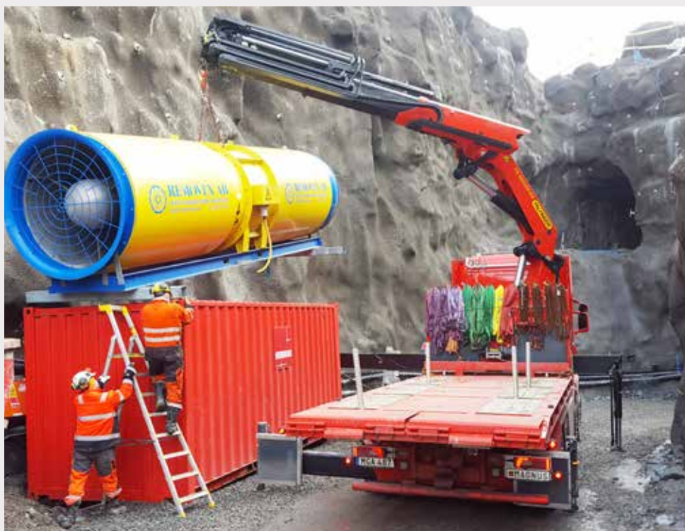
Speciallösning med bl a vinsch, containerlås, ramper, stakar, placering på stakhål, utformning på framstam, flaklängd.
